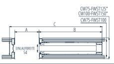
FWST = Fertigwandstärke | CW = Profilstärke | \* Doppelbeplankung
